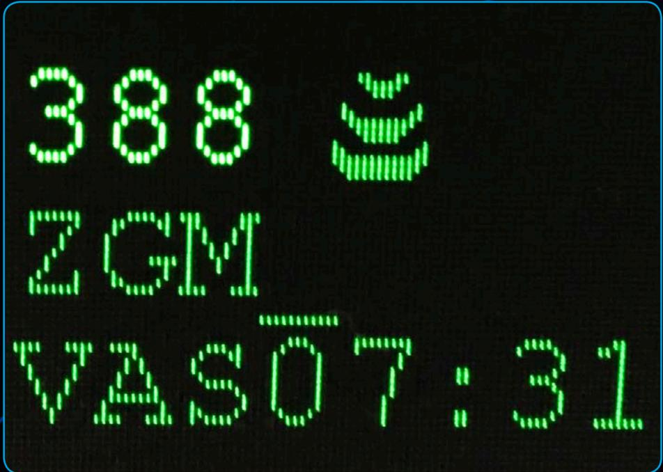
Etiqueta de pista radar con indicación de aeronave con capacidad CPDLC (enlace de datos controlador-piloto), una nueva prestación del sistema SACTA
